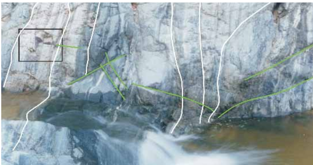
8. Típico cauce de los ríos del litoral central, donde el curso del agua es perpendicular a los planos de foliación (blanco) y paralelos a los planos de diaclasas (verde). Se destacan en el detalle los planos (foliación y diaclasas) que permitirían que un pequeño bloque cayera al agua.
